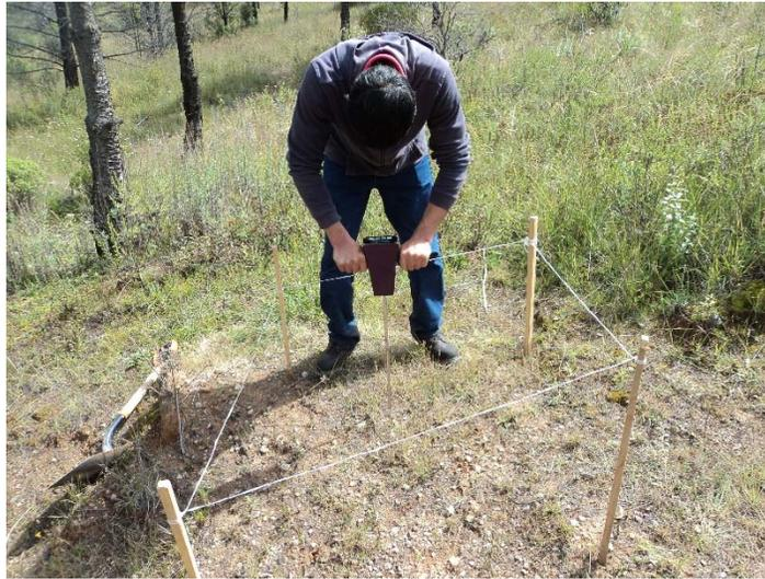
**Figura 3.12.** Medición de la compactación mediante un penetrometro SC 900
